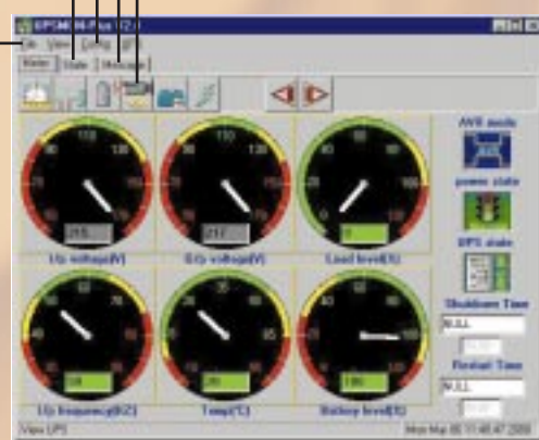
Pantalla de monitorización intuitiva, que facilita una visión rápida de la alimentación y condiciones ambientales para la detección de los problemas y su diagnóstico.
